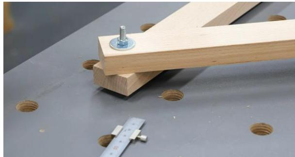
Schritt 3: Zwei Balken durch jeweils 1x Sechskantschraube, 2x Unterlegscheiben und 1x Mutter verbinden.
