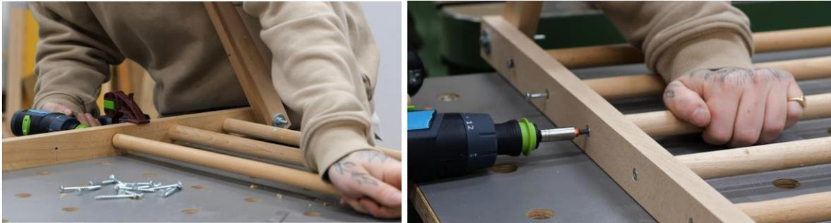
Schritt 9: Verschrauben der Rundstäbe mit den beiden Rahmen des Kletterdreiecks.
