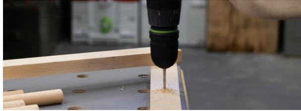
Schritt 6: Löcher vorbohren.
