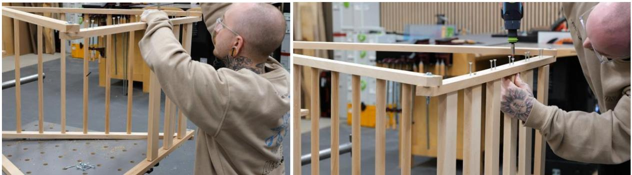
Schritt 10: Vorbereitung und Zuschnitt der Treppenstufen, Vorbohren der Balken und mit dem Rahmen des Kletterdreiecks doppelt verbohren.
