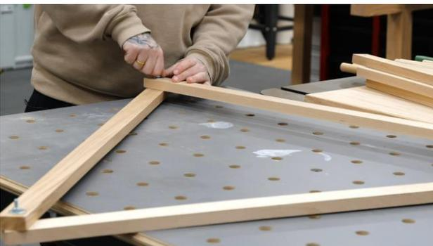
Schritt 4: Zusammenbau des ersten Dreiecks für den Rahmen.
