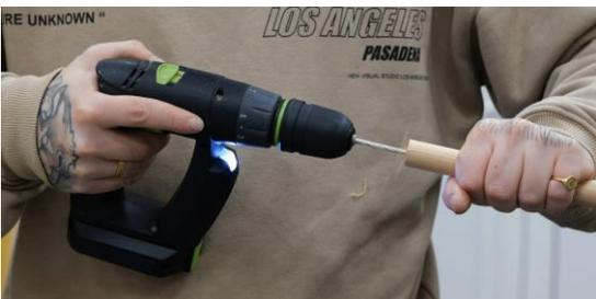
Schritt 8: Rundstäbe zuschneiden, die jeweilige Mitte zum Vorbohren anzeichnen und beidseitig vorbohren.
