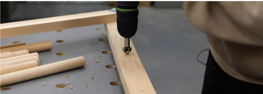
Schritt 7: Löcher vorsenken, damit die Schrauben beim anschließenden Verschrauben bündig sitzen.
